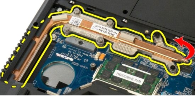
7. เคลื่อนแถบระบายความร้อนไปที่ตรงกลางของคอมพิวเตอร์ แล้วจึงยกแถบระบายความร้อนขึ้น ก่อนถอดออกจากคอมพิวเตอร์
